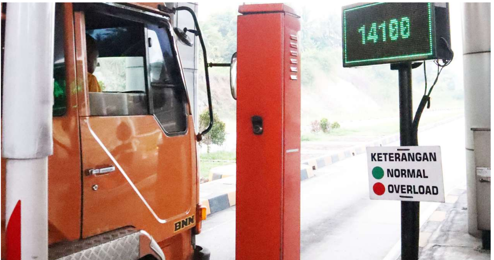
Pengendalian Kendaraan Over Dimensi Over Load menggunakan WIM
