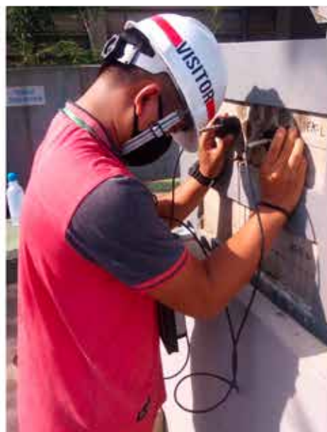
Pengamatan ke dalam retak dengan alat UPV
