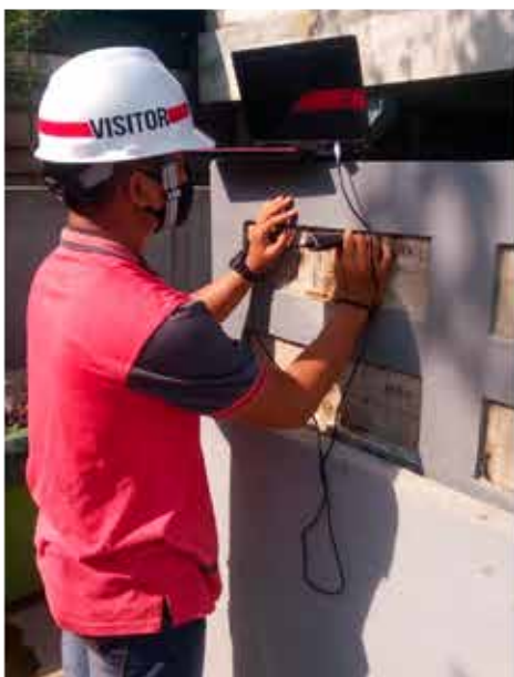
Pengamatan lebar retak dengan kamera digital mikroskop
